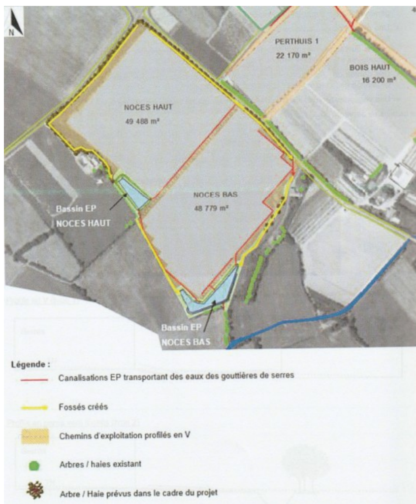
Figure 2: plan de gestion des eaux pluviales (source : dossier d'autorisation environnementale page 74)
